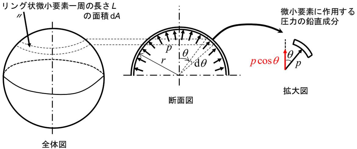
(4) 図のような球面座標  $(r, \phi, \theta)$  において微小要素を考える．今、垂直応力  $\sigma_r, \sigma_\phi, \sigma_\theta$  のみが作用しており、さらに  $\sigma_\phi = \sigma_\theta$  の状態とする．Mises の降伏条件より、 $\sigma_r - \sigma_\theta = Y$  ( $Y$  は単軸引張の降伏応力) が得られることを示せ．
