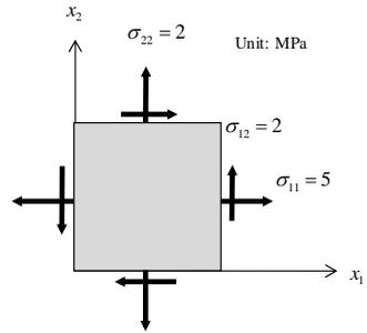
1 6. 微小立方体要素が左下図のような応力を受けている (負の面にも同様の応力が作用しているが図示していない).
