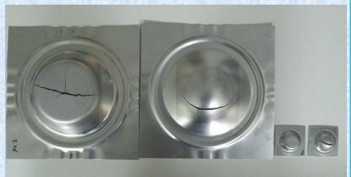
Fig. 2 破断後の試験片 左からISO平頭, ISO球頭, 小型平頭, 小型球頭
